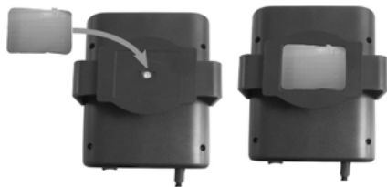
2 pav.: Lipnių juostų montavimas
